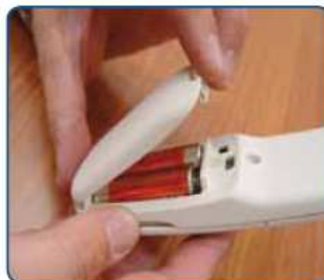
Obrázok 4.1 Výmena batérií v ovládači v staniách
